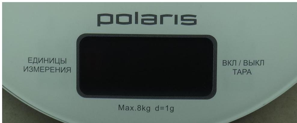
Включение/выключение весов и обнуление тары осуществляется сенсором **ВКЛ/ВЫКЛ ТАРА**, расположенным справа от дисплея. Для выключения нажмите и удерживайте кнопку “Вкл/Выкл Тара” в течение более 2-х секунд.
